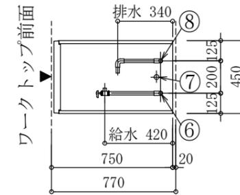
食器洗浄機配管 (平面)
