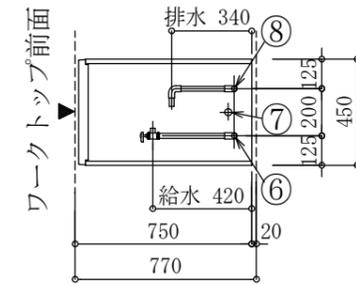
食器洗浄機配管 (平面)
